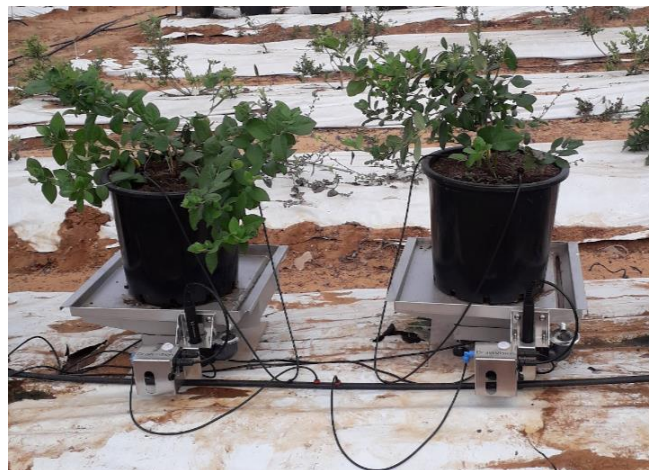
תמונה 11: עמדת בקרה אוטומטית של אחוז נקז, EC ו-pH של מי הנקז באמצעות מערכת DRAINVISION מתוצרת חברת PASKAL, בגידול אוכמניות במצע מנותק
