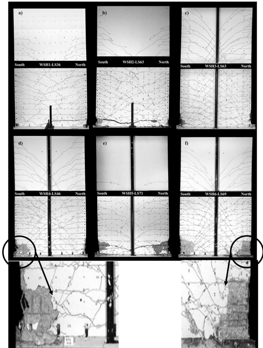
הגדלה מקומית כשל בקיר WSH4 הגדלה מקומית כשל בקיר WSH6 איור מספר 21 - תמונות הסדקים והנזקים שהובחנו בקירות השונים, בשלבי העמסה מוקדמים ומתקדמים, עבור דגמי הקירות השונים (Dazio, et al., 2009).
