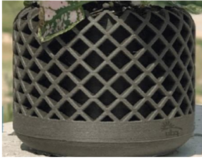
תמונה 27: דוגמה להדפסה בקנה מידה קטן בפילמנט תוצרת Plastics-App שמשלב UBQ עם Carbon fiber
