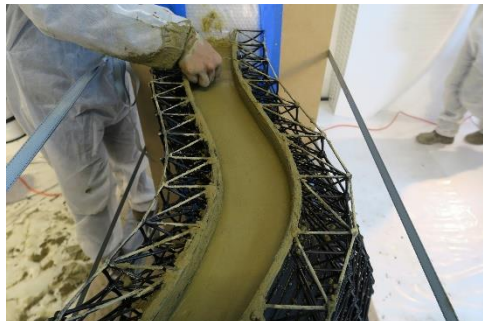
תמונה 3: תבנית יציקה מודפסת הניתנת למחזור, חברת AI Build
