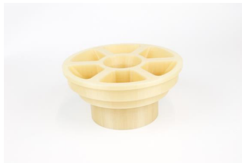
תמונה 19: חלק מכני מודפס מפילמנט-PLA colorfabb: PHA מקור.
