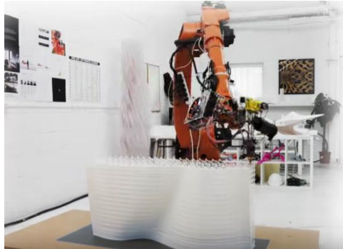
תמונה 2 : ייצור אלמנט מבני בעזרת זרוע רובוטית, חברת AI Build
