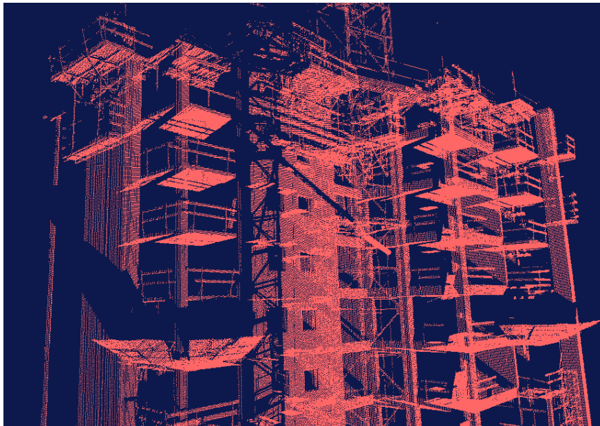
איור 6-8 הסתרות בענן הנקודות הנגרמות מחסימת קו הראייה בין הסורק לאובייקט על ידי מכשולים הקיימים בשטח (כגון מרפסות והעגורן עצמו)
