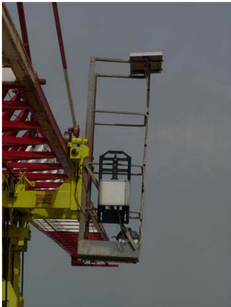
איור 4-8 אתר הניסוי: מצלמה כעזר ראייה (מימין: המצלמה על הזרוע הקדמית של העגורן; משמאל: תקריב של מתקן המצלמה)
