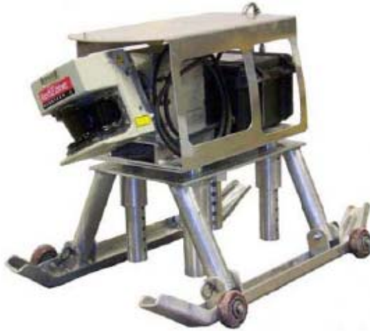
איור 3-25 סורק הלייזר על המגלשה, מותאם למעבר בצינורות שונים (Hallmark ו-Thayer 2009)
