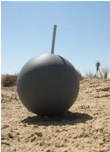
איור 4-13 ספירות (כדורים) המשמשות לעיגון סריקות הלייזר (מימין: ספירה על חצובה; משמאל: תקריב של ספירה על רקע סורק הלייזר)
