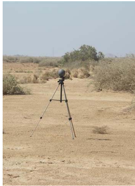
איור 4-13 ספירות (כדורים) המשמשות לעיגון סריקות הלייזר (מימין: ספירה על חצובה; משמאל: תקריב של ספירה על רקע סורק הלייזר)
