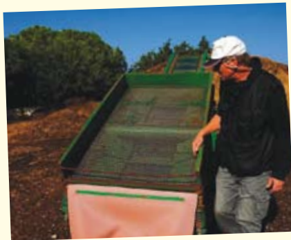
תמונה 5. נפה למיין גודל חלקיקים של רסק גזם עץ המשמש לחיפוי בגנים הבהאים שבחיפה
