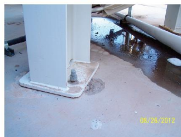
איור 4-6.4.2.1 – מיכלים ביקב שנפגעו ברעידת אדמה. ניתן לראות כשלים שונים: כשל בעיגון ברגים, כשל בקריסה של רגלי התמיכה, כשל בריתוכים. שימוש בברגים לפילוס גובה המיכלים גרם ליצירת אזור חלש בין תחתית הרגלים לרצפת חלל האחסון.
