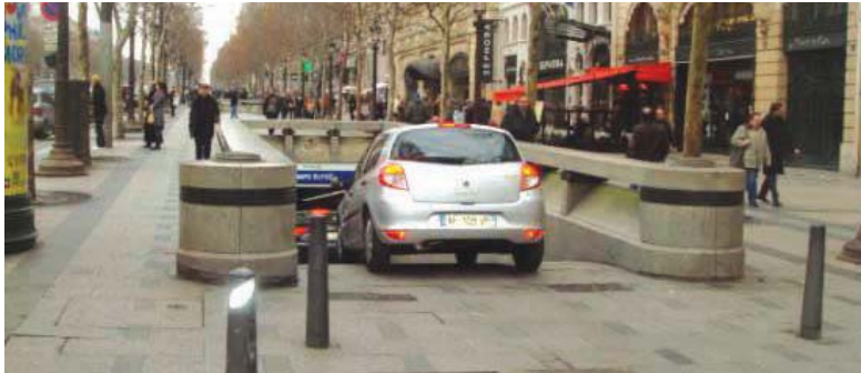
כניסה לחניון תת-קרקעי בשדרות שאנז-אליזה, פריז. הרמפות החד-כיווניות מעוצבות כחלק משפת הרחוב ותופסות שטח מינימלי, בשיפוע של 17%.
