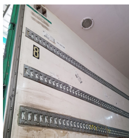
פס עיגון בתוך ארגז סגור למניעת תזוזה של מטען באמצעות מוט טלסקופי.
