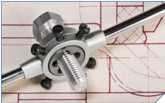
איור 2.3.17: ביצוע תבריג במחרוקת
