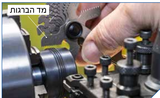
איור 2.3.37: בדיקת פסיעת התבריג
