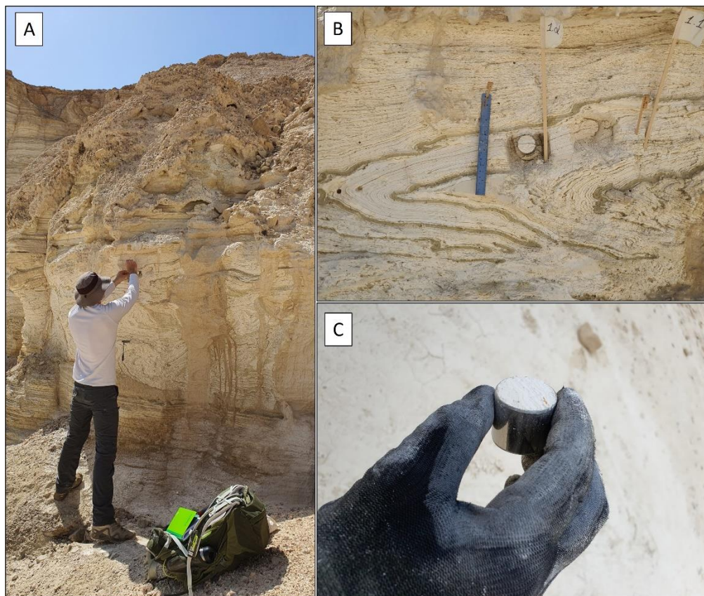
איור 5.4: דוגמה לדיגום בשדה (אתר PZ09) עבור מדידת נפח ישירה באמצעות צינור נירוסטה. A. תמונה של המחשוף שנדגם. B. צינור נירוסטה מוחדר לתוך סדימנט בשכבה שנדגמת. C. צינור נירוסטה כאשר כל נפחו מלא בסדימנט לאחר חילוץ מהשכבה.
