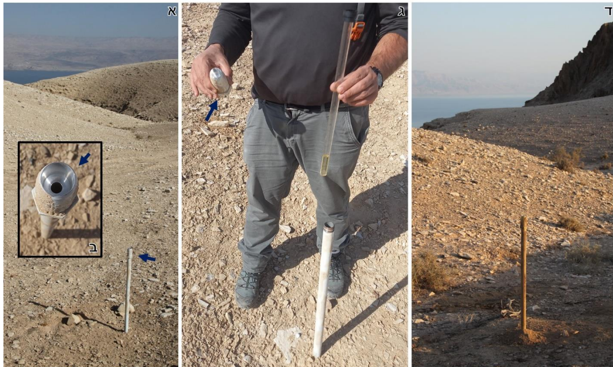
איור 6.14: מדי גשם זעירים (מג"זים). (א) המג"ז הצפוני ביותר הוצב ממזרח לג'בל חרמון. ראש המג"ז (חצים כחולים) מוברג אל צינור הברזל, כשפתחו העליון ממוקם כ- 0.8 מ' מעל הקרקע. (ב) צילום מלמעלה של פתח איסוף הגשם במג"ז. (ג) המג"ז במצבו הפתוח בזמן מדידה. אנו מוסיפים שמן על מנת למנוע אידוי מים מהמבחנה. (ד) תמונת מג"ז נוסף שמוקם בראש המצוק באזור נחל קנה.
