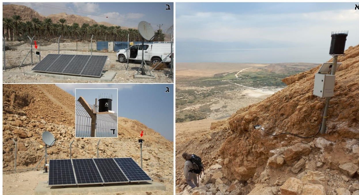
איור 6.15: מדי גשם אוטומטיים. (א) תחנה המשדרת נתוני גשם וצילומים מבסיס מצוק ההעתקים וממוקמת מצפון מערב לשמורת עין פשחה. (ב) מדי גשם (חץ אדום) בתחום תחנת תרועה במורד נחל תמרים. (ג) מדי גשם (חץ אדום) בתחום תחנת תרועה שמעל היישוב אבנת. (ד) הגדלה של מדי הגשם המצולם ב- ג', בראשו דוקרנים להרחקת ציפורים.
