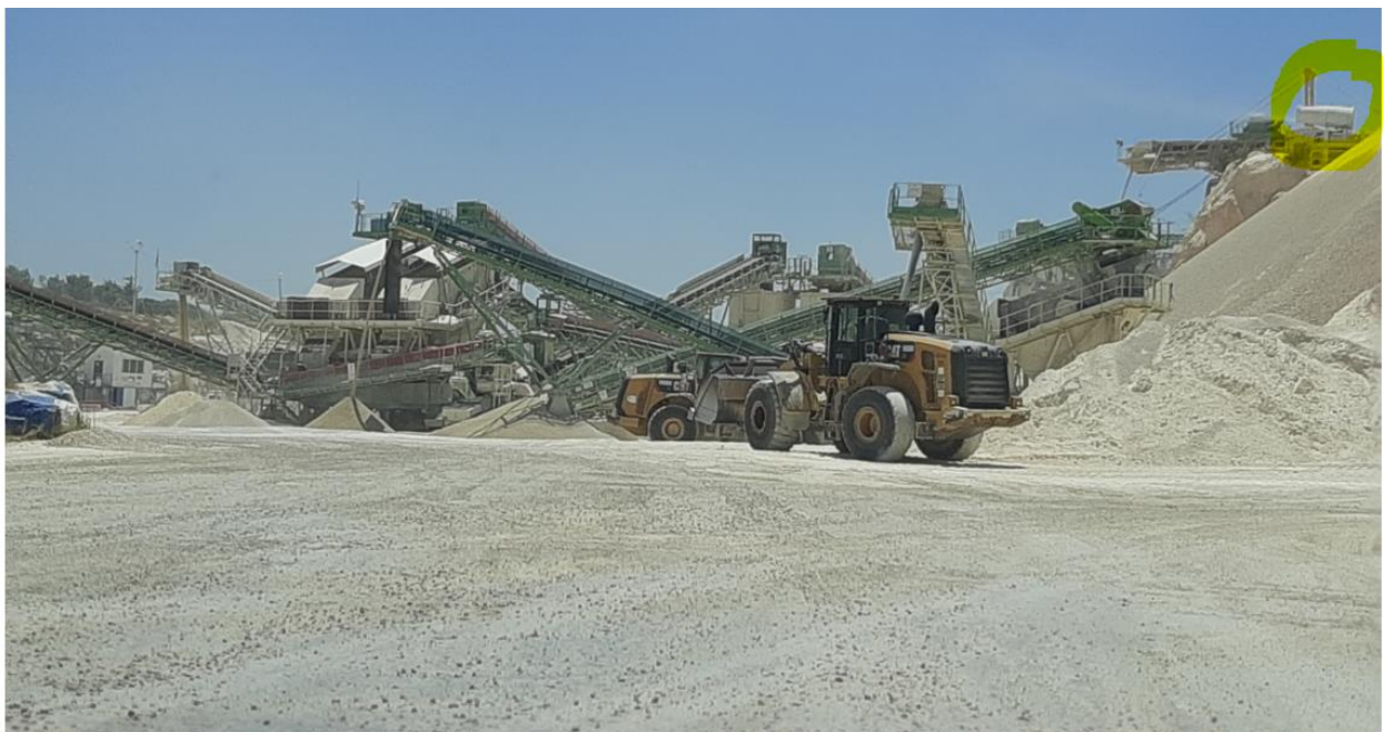
תמונה 2- מימין בצבע צהוב: תותח מים, משמאל- מסועים במחצבה. ניתן לראות כי לא קיימים שרולים או שהינם בלויים.
