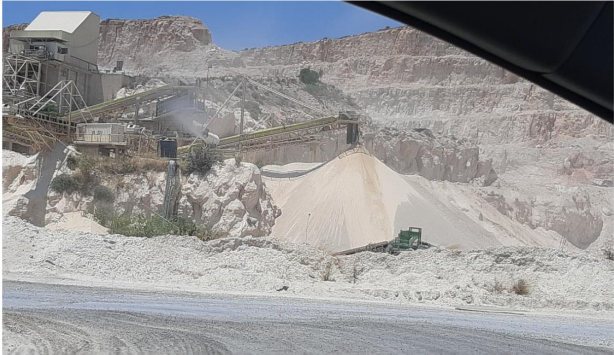
תמונה 1- משמאל: תותח מים, מימין: מסוע ממנו מתבצעת שפיכת חומר מינרלי לערמה
