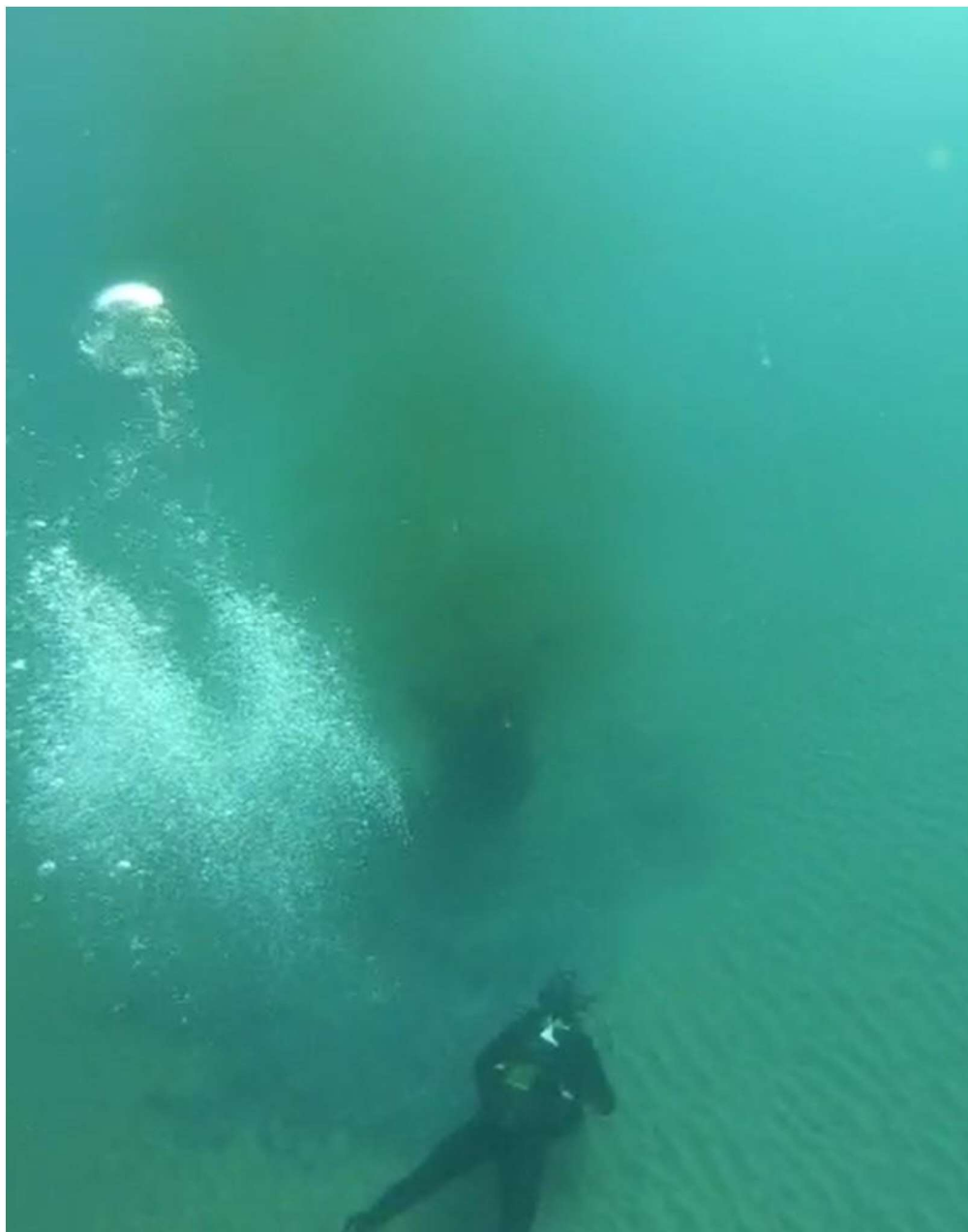
תמונה 1 - התרוממות ומיהול של המים המוזרמים לים , עומק המוצא כ- 10 מטר
