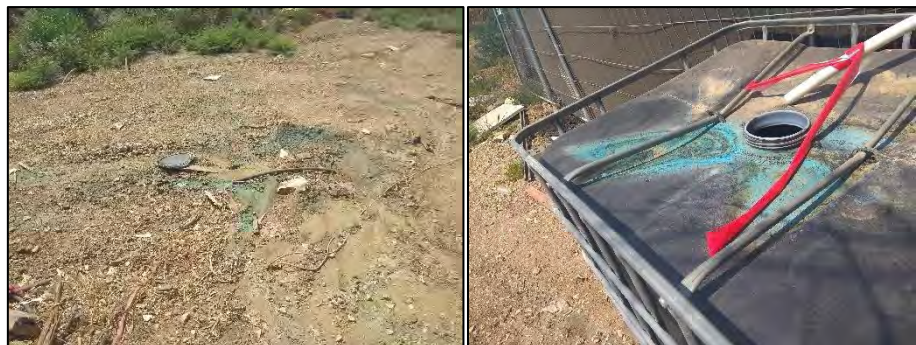
איור 29: חומר כחול זורם על פני הקרקע. מימין מכל האגירה, ומשמאל סימני זרימה בשטח.
