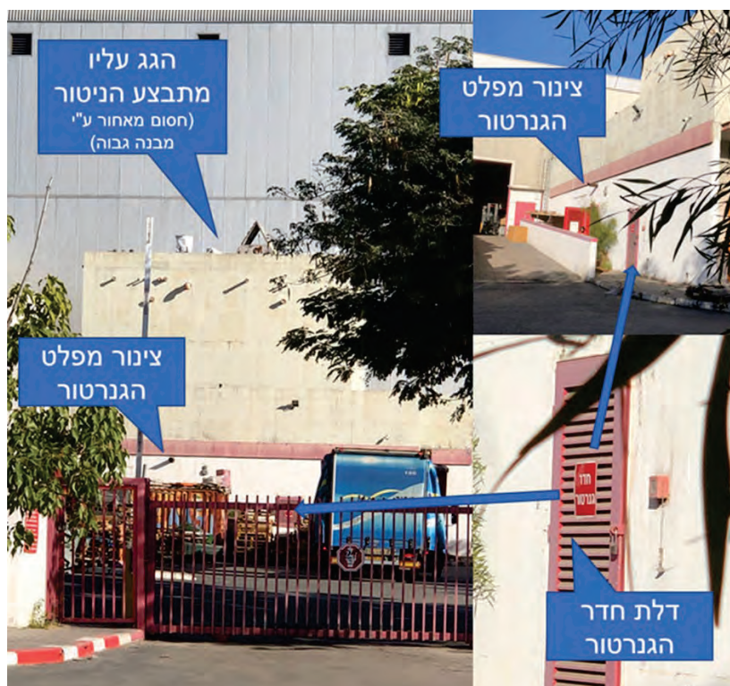
תמונה 5: חדר הגנרטור וצינור המפלט שלו, מתחת לנקודת הניטור באתר המחסן הלוגיסטי של הוס סנטר
