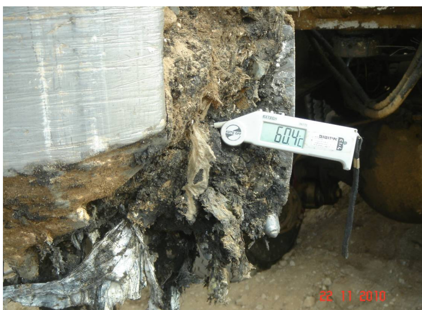
תמונה מס' 9: מדידת טמפרטורה באמצעות מד חום בדוגמת פסולת שהוצאה מקידוח עומק.
