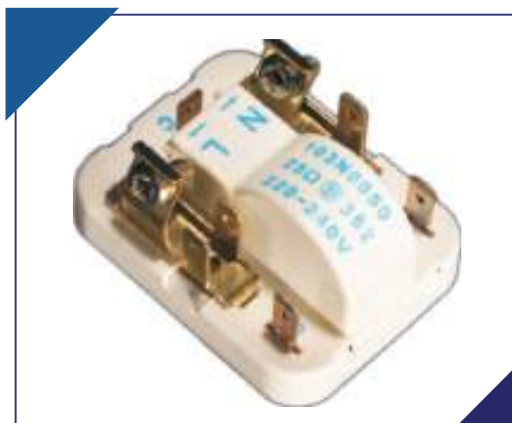
תמונה 4.111 - ממסר התנעה מסוג PTC משולב עם הגנת זרם יתר
