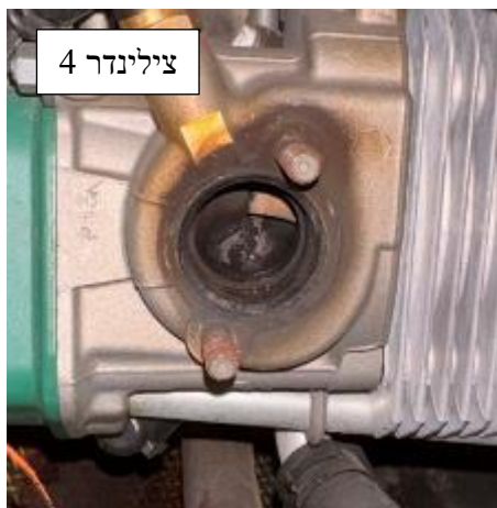
תמונה 32 - סימני הפיח מרוכזים בצידו העליון ימני של פתח חיבור האגוז 4
