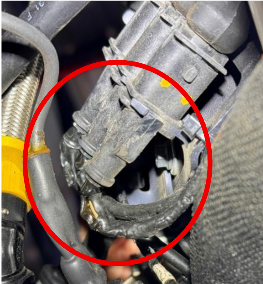
תמונה 34 - פגיעה במחברי חיישני המנוע המצביעה על חשיפה לחום גבוה
