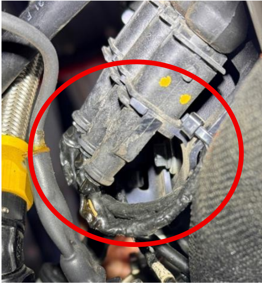
תמונה 16 - הגדלה של אזור הפגיעה במחברי חיישני המנוע
