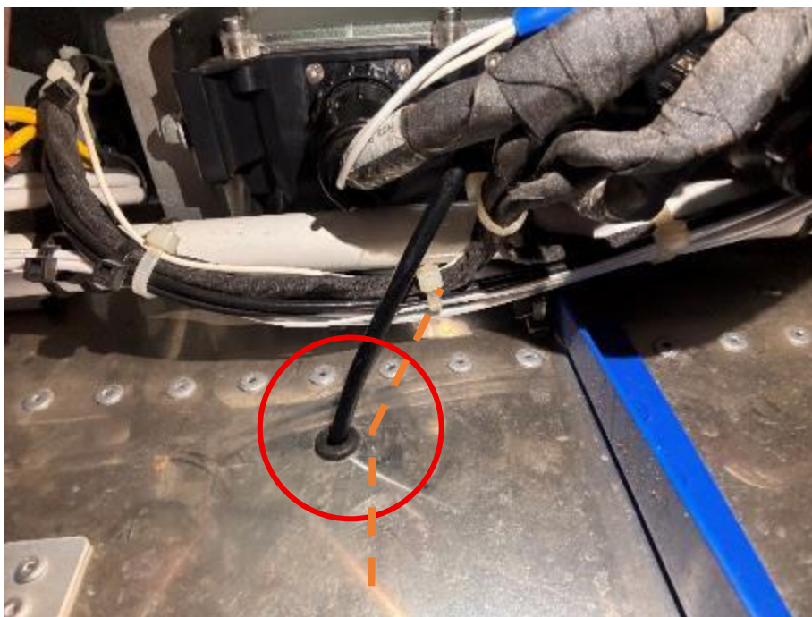
תמונה 12 - תמונות יציאת הכבל מקיר האש במטוס התאונה - מבט מלמטה
