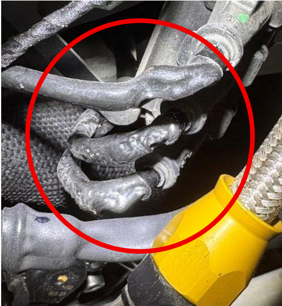
תמונה 17 - הגדלה של אזור הפגיעה במחברי חיישני המנוע המראה בועות והתכה
