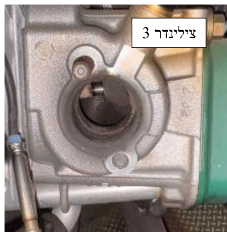
תמונה 32 - סימני הפיח מרוכזים בצידו העליון ימני של פתח חיבור האגוז 4
