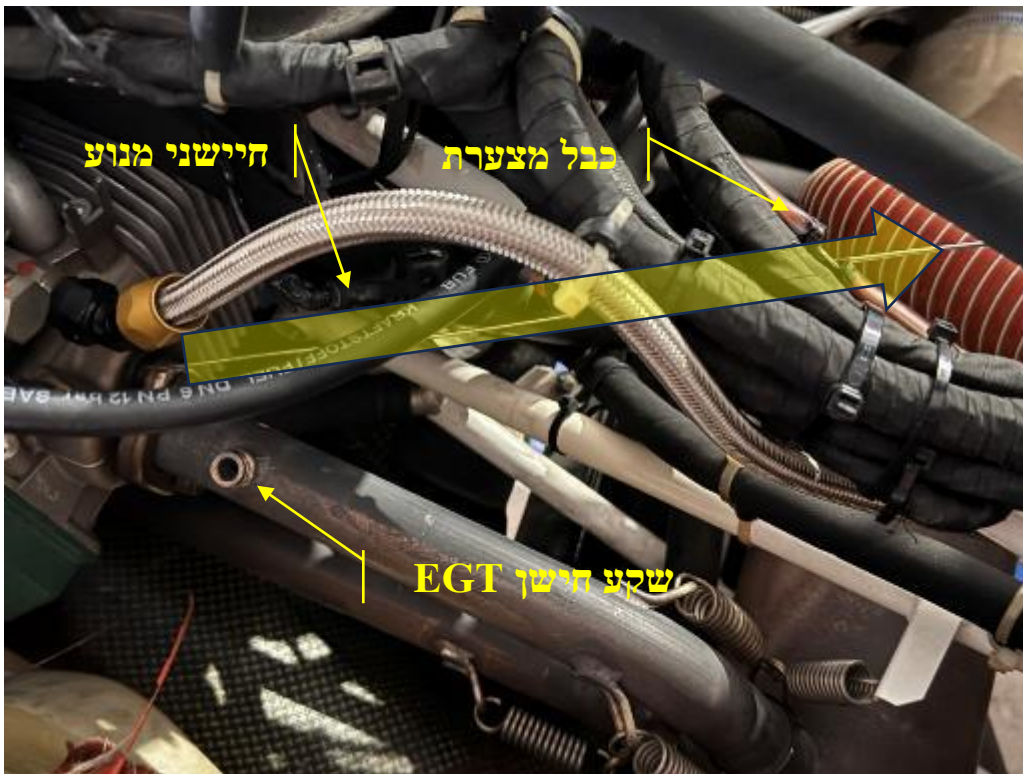
תמונה 33 - כיוון התקדמות הגזים החמים מצילינדר 4 ועד הפגיעה בכבל המצערת
