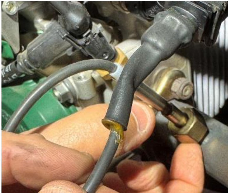
תמונה 18 - התכת מחבר חיישן הטמפרטורה החדש
