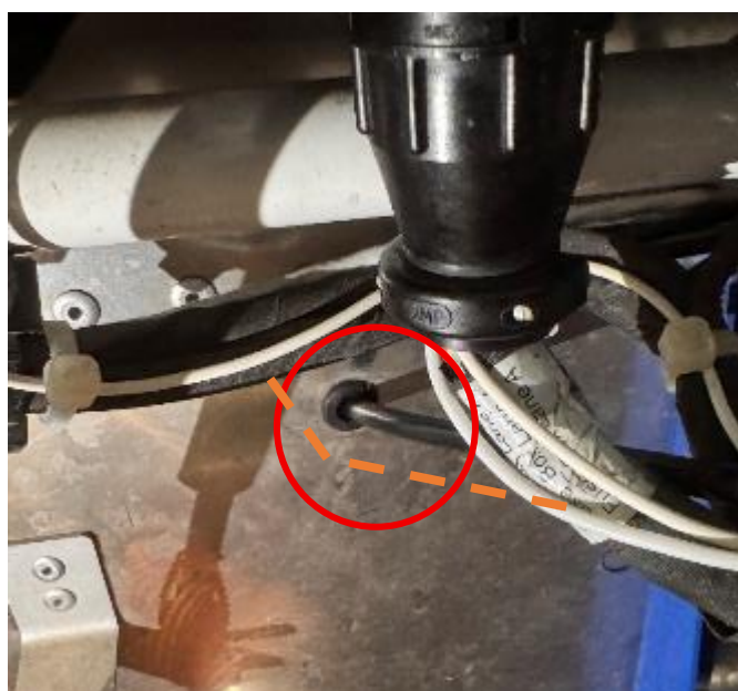
תמונה 13 - תמונות יציאת הכבל מקיר האש והסטנו ע"י צמות חשמל. מבט מלפנים
