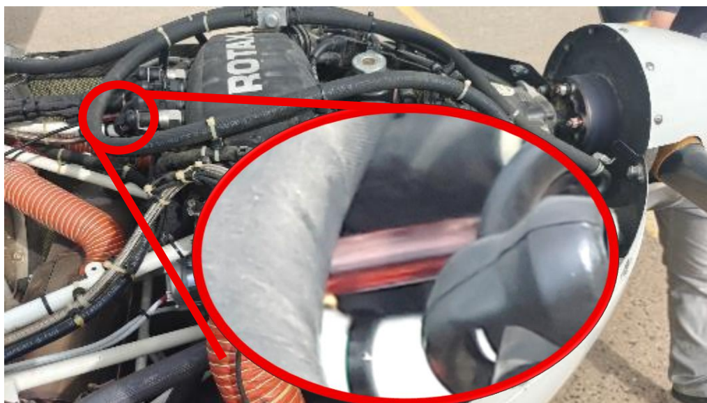
תמונה 36 - בתמונה נראים סימני חום על גבי הצינורית השקופה של כבל המצערת.
