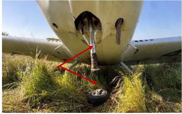
כן הנסע הקדמי התכופף לאחור והגלגל ניתק
