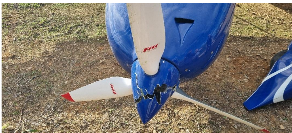
תמונה 6 - פגיעה בספינר + גלגל קדמי מנותק
