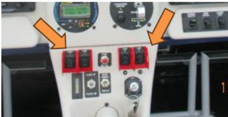
Figure Errore. Nel documento non esiste testo dello stile specificato. 2: Example of safety guards correctly installed
